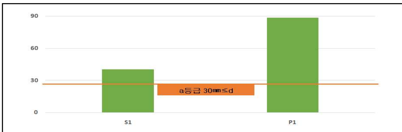
【그림 3.14】 탄산화 깊이 측정결과
