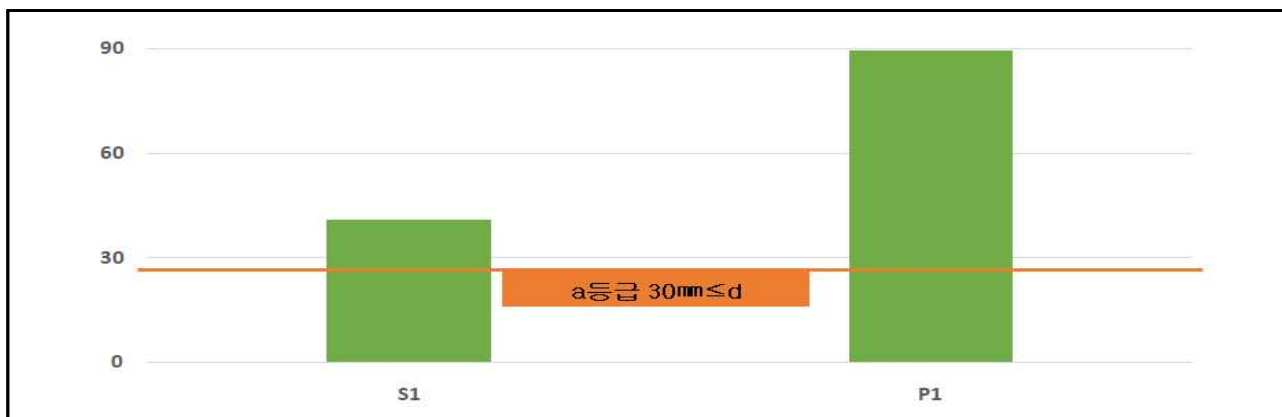
【그림 3.11】 탄산화 깊이 측정결과
